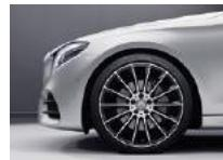
Bitte beachten Sie: Je geringer bei einer bestimmten Radgröße der Querschnitt der Reifen ist, desto schlechter ist der Fahrkomfort auf schlechten Straßen. Abroll- und Dämpfungskomfort nehmen ab und die Gefahr, dass es beim Überfahren von Hindernissen zu Beschädigung von Reifen und Rädern kommt, steigt.
